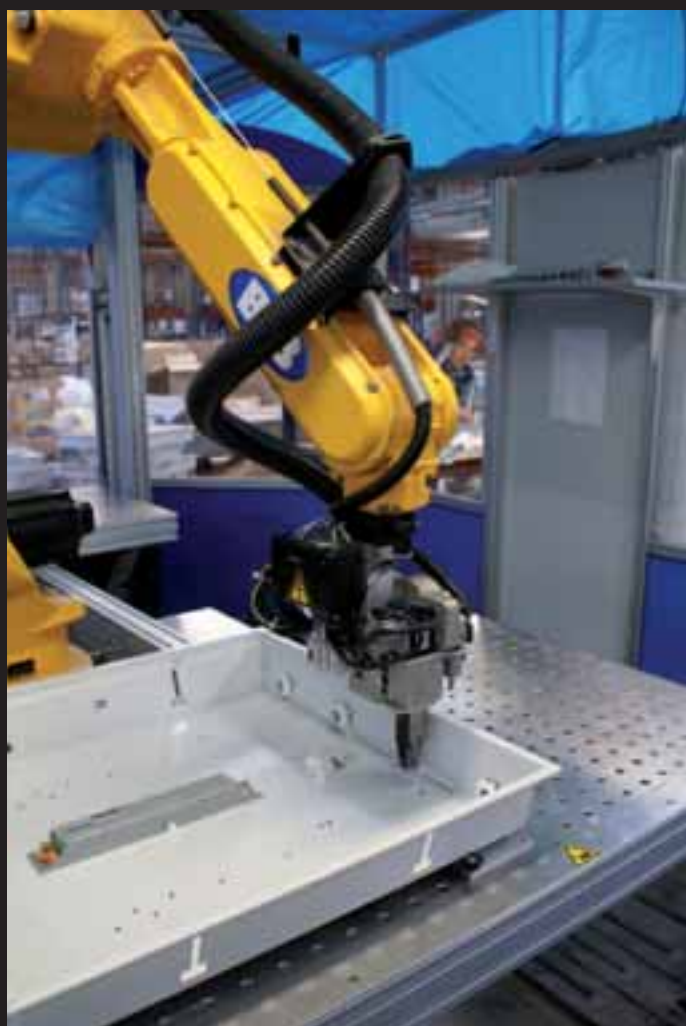
Robot de câblage automatique
