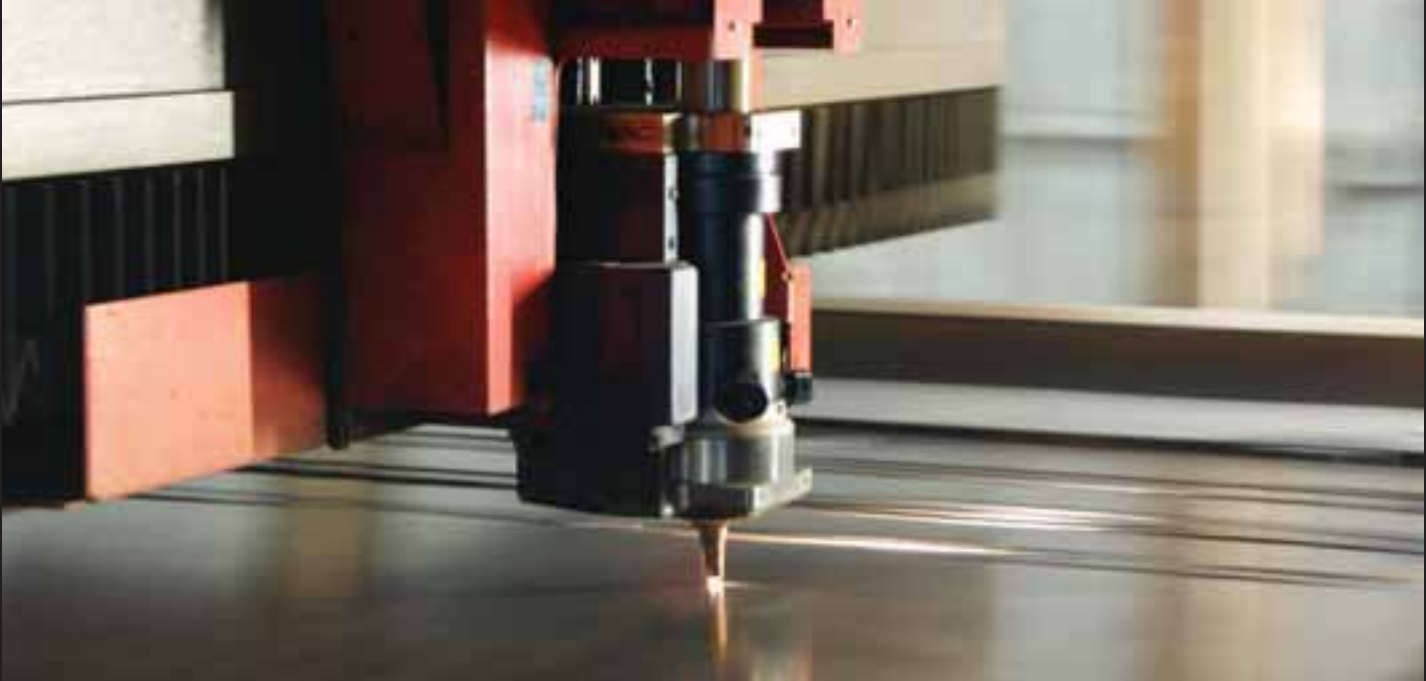
Equipement de découpage laser pour l'aluminium et différents alliages pour la fabrication de composants.
