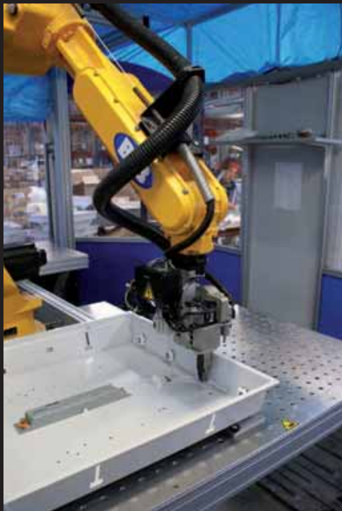
Robot de cableado automático.
