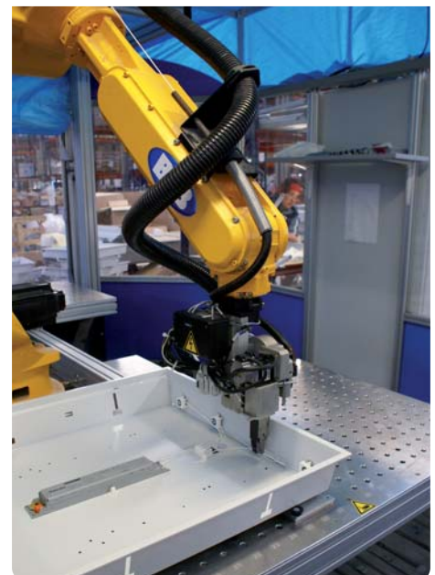
Cella di cablaggio robotizzato. Disposito de electrificação robotizado de luminarias.
