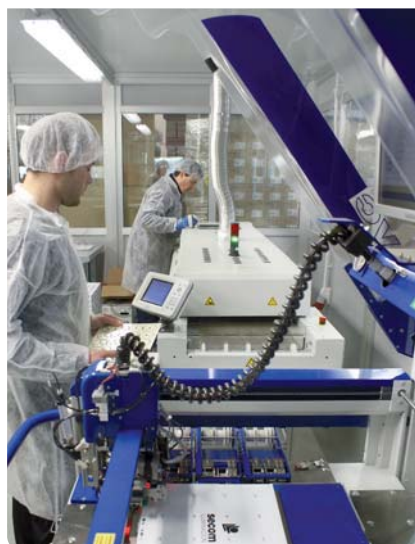
Robot Pick & Place e forno di rifusione per convezione. Máquina Pick & Place e forno de fusão por convecção.
