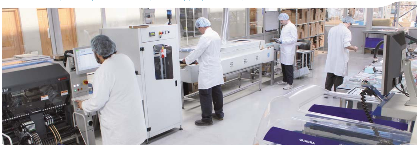
Robot Pick & Place e forno di rifusione per convezione. Máquina Pick & Place e forno de fusão por convecção.
