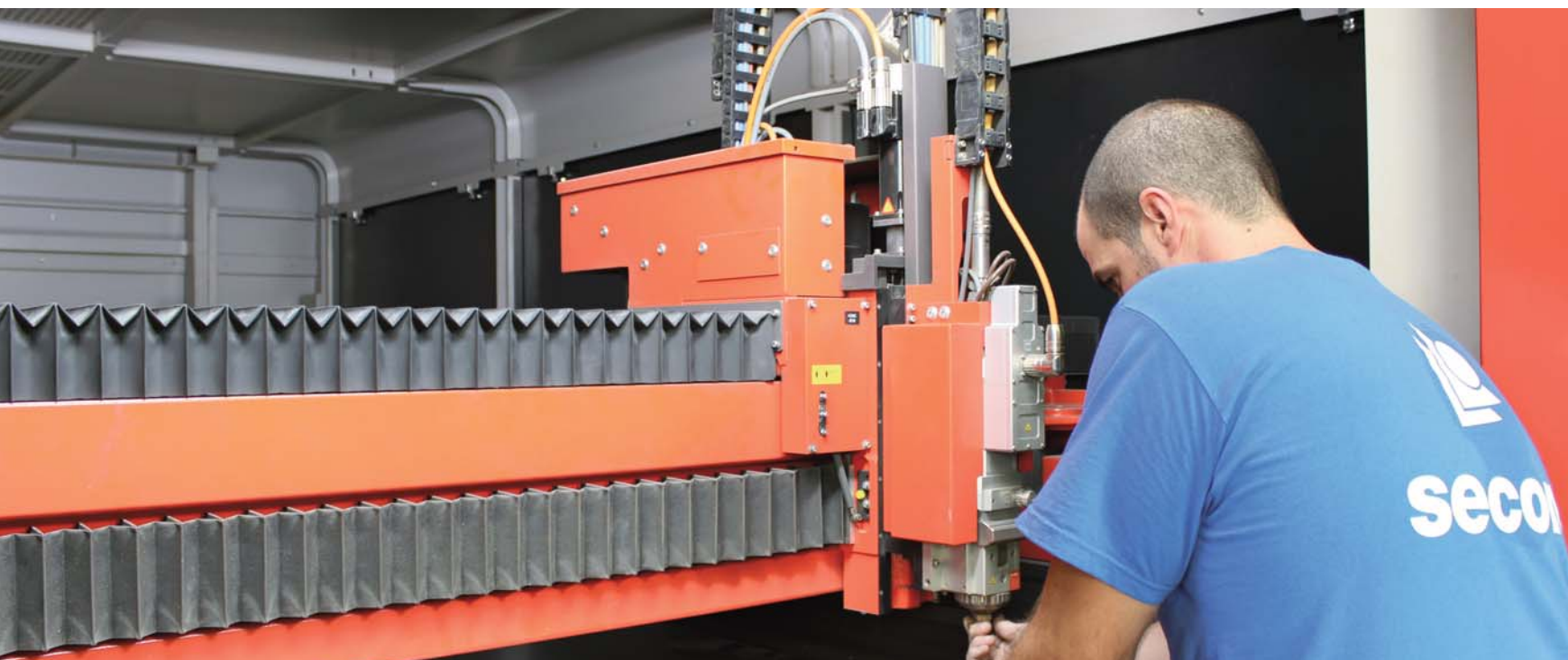
Macchina per il taglio laser dell'alluminio e di altre leghe per la fabbricazione di componenti. Máquina de corte a laser para alumínio e outras ligas, para o fabrico de componentes.
