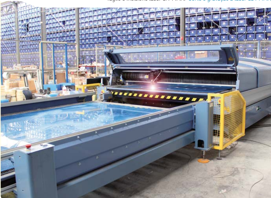
Taglio e incisione laser di PMMA. Corte e gravação a laser da PMMA.
