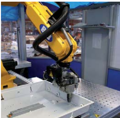
Robot de cableado automático. Robotized wiring cell.
