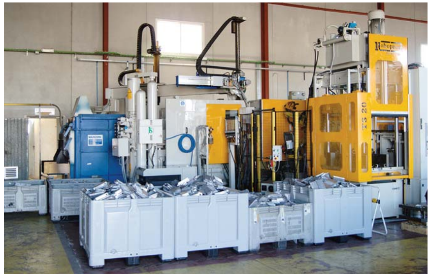
Máquina de inyección de aluminio. Aluminum injection machine.
