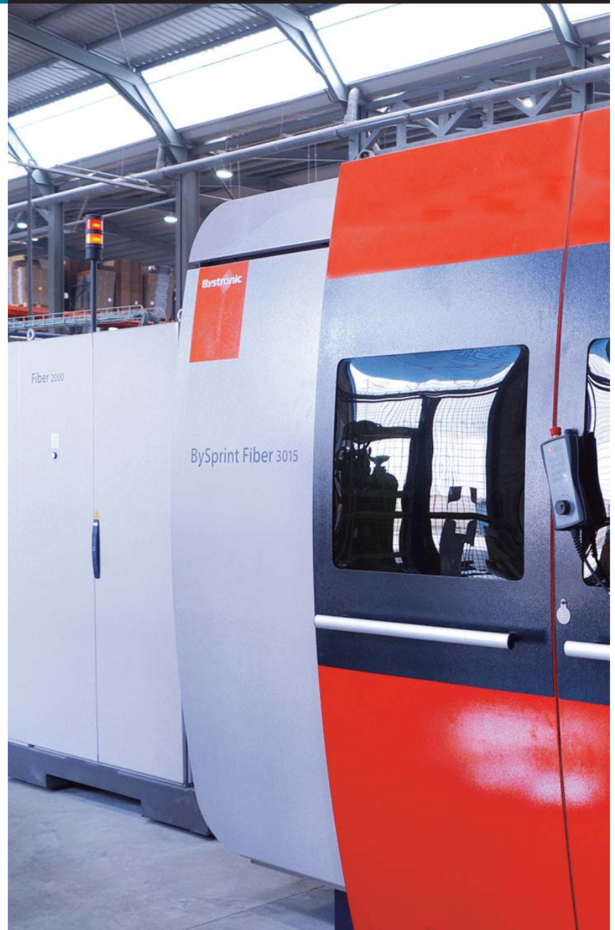
Equipo de corte laser para aluminio y distintas aleaciones para la fabricación de componentes. Laser cutting equipment for aluminum and other alloys for the manufacture of components.
