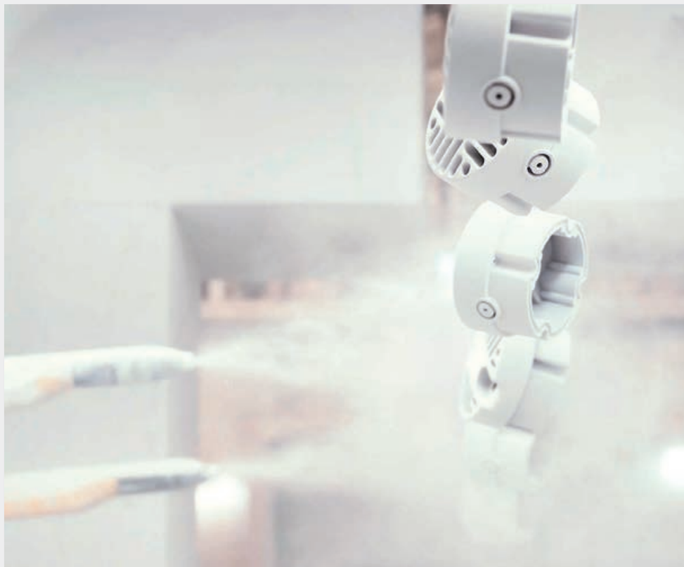
TUNEL DE PINTURA EN POLVO AUTOMÁTICO Y HORNO DE POLIMERIZADO AUTOMATIC POWDER PAINT TUNNEL AND POLYMERISATION OVEN
