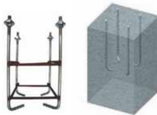
Detalle de la cimentación
