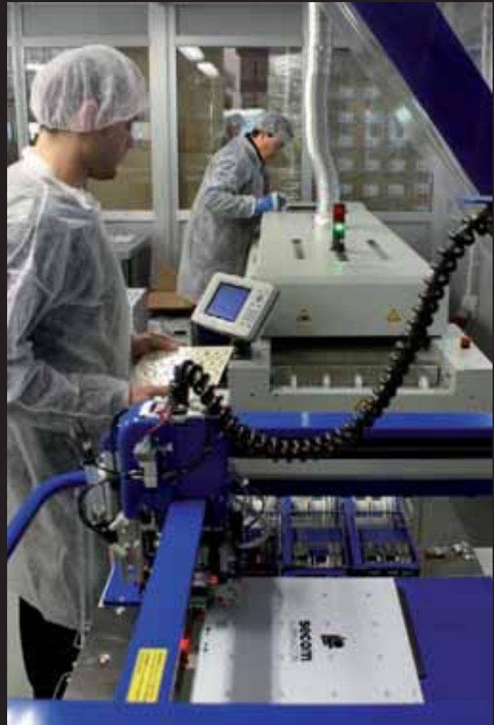
Máquina Pick & Place y horno de refusión por convección
