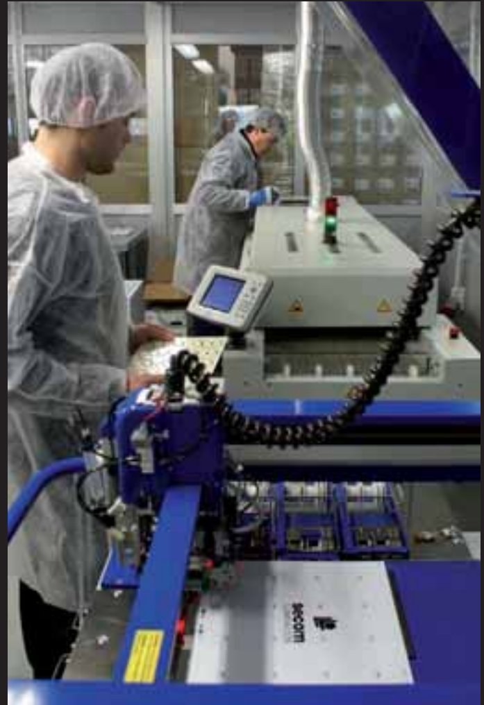
Machine Pick and Place et four à fusion par convection.
