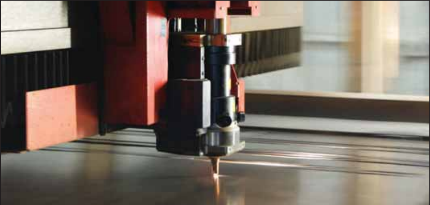
Equipamento de corte a laser para alumínio e distintas aleações para a fabricação de componentes.
