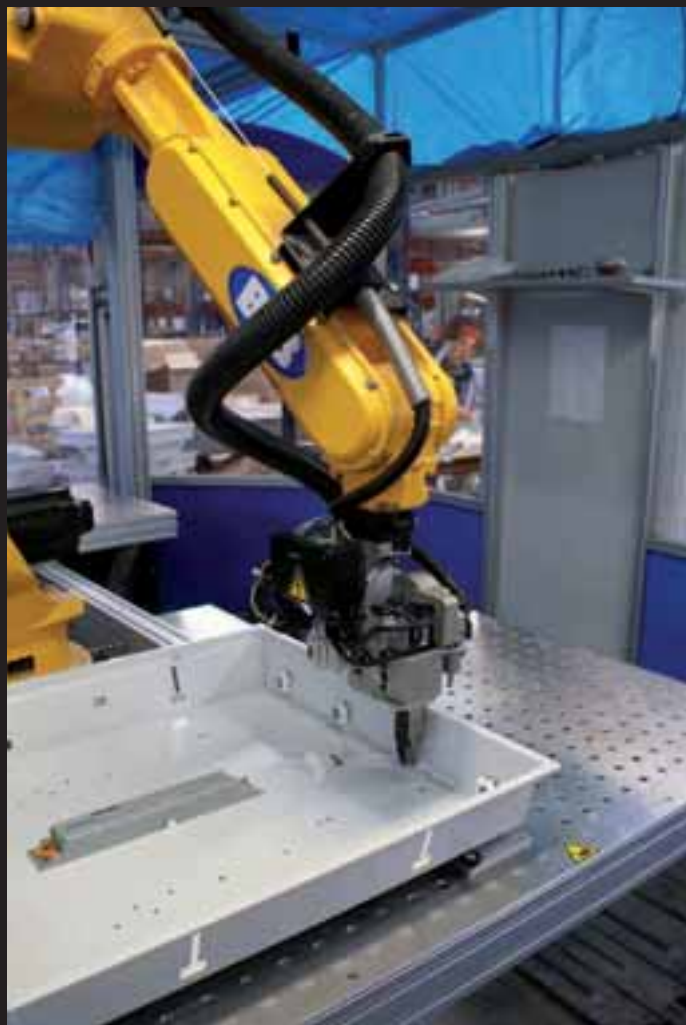
Robô de cabeamento automático
