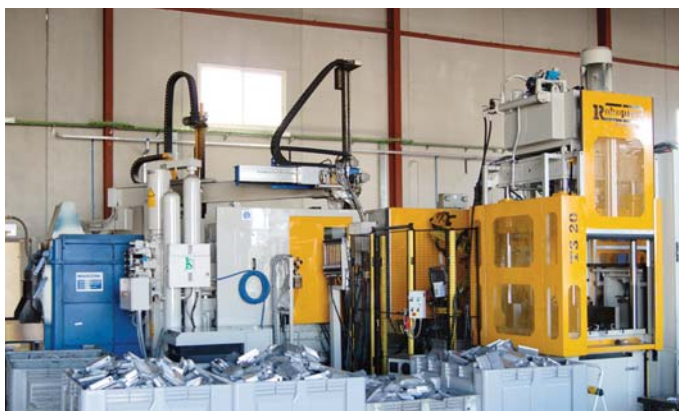
2 máquina de inyección de aluminio. 2 aluminum injection machine.
