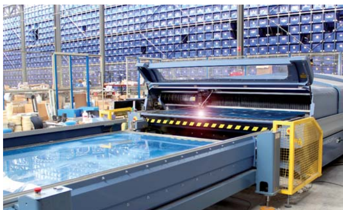
Láser de corte y grabado de PMMA. Cutting and engraving laser of PMMA.
