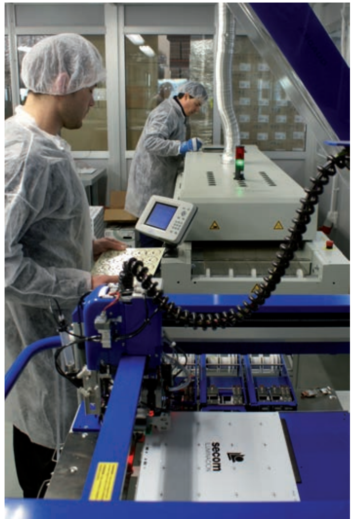
Máquina Pick & Place y horno de refusión por convección. Pick & Place robot and convection reflow oven.
