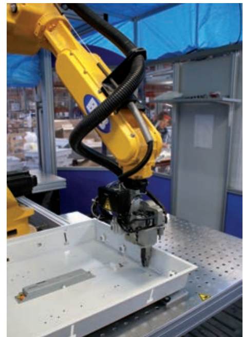
Robot de cableado automático / Robotized wiring cell.
