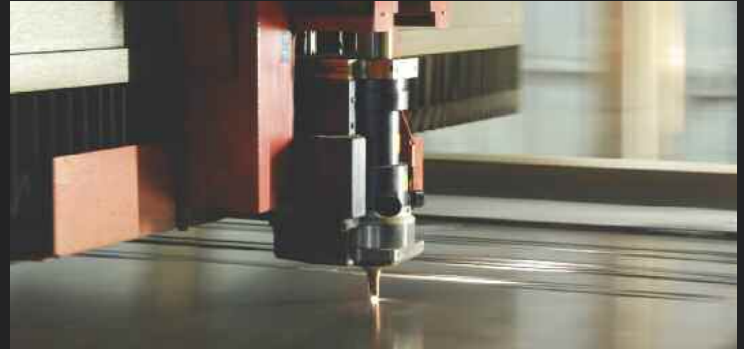
Equipo de corte laser para aluminio y distintas aleaciones para la fabricación de componentes.
