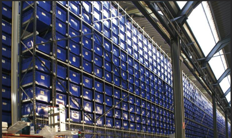
Sistema de almacén y dispensación robotizada de productos / Robotized warehousing system.
