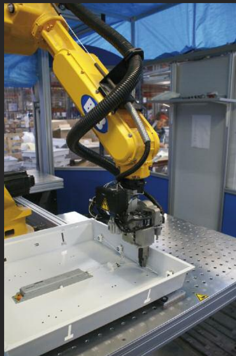
Robot de cableado automático / Robotized wiring cell.
