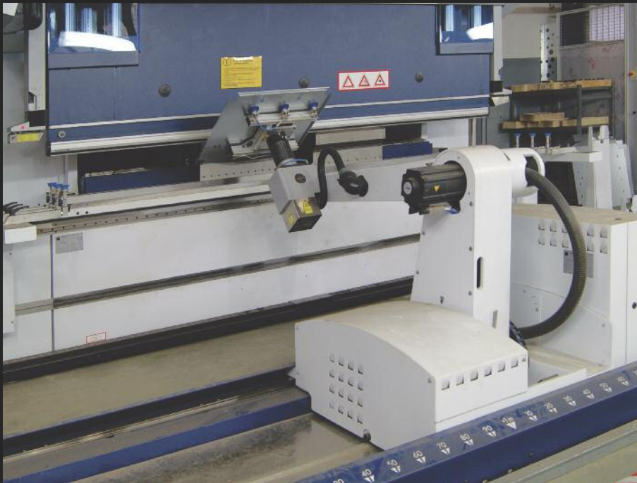
Plegadora con robot / Robotized folding machine.
