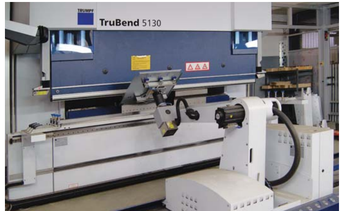
Plegadora con robot. Robotized folding machine.
