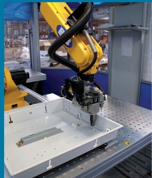
Cella di cablaggio robotizzato. Dispositivo de eletrificação robotizado de luminarias.
