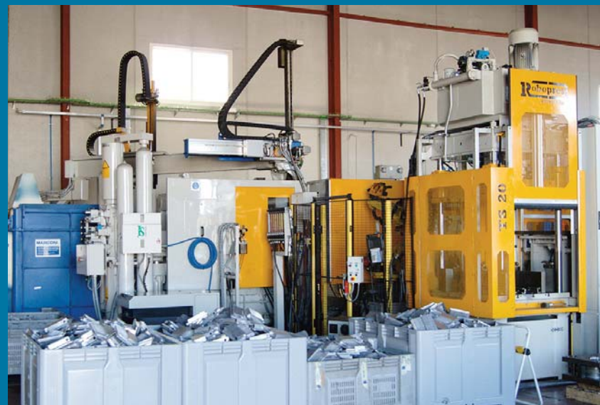
Macchina per iniezione di alluminio. Máquina de injeção de alumínio.
