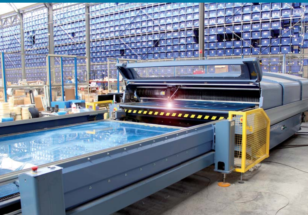
Taglio e incisione laser di PMMA. Corte e gravação a laser da PMMA.
