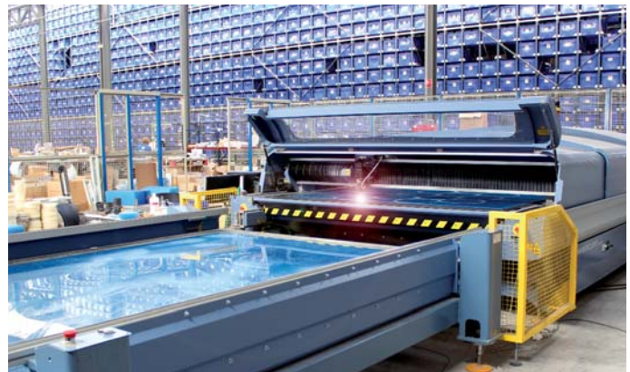
Láser de corte y grabado de PMMA. Cutting and engraving laser of PMMA.
