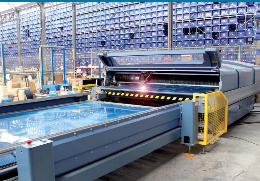
Cutting and engraving laser of PMMA. Découpe et gravure au laser de PMMA.
