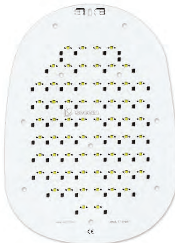
Sheet PCB ECODUT K2 / Oslon SSL
