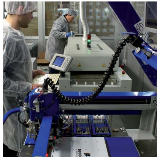
Máquina Pick & Place y horno de refusión por convección. Pick & Place robot and convection reflow oven.
