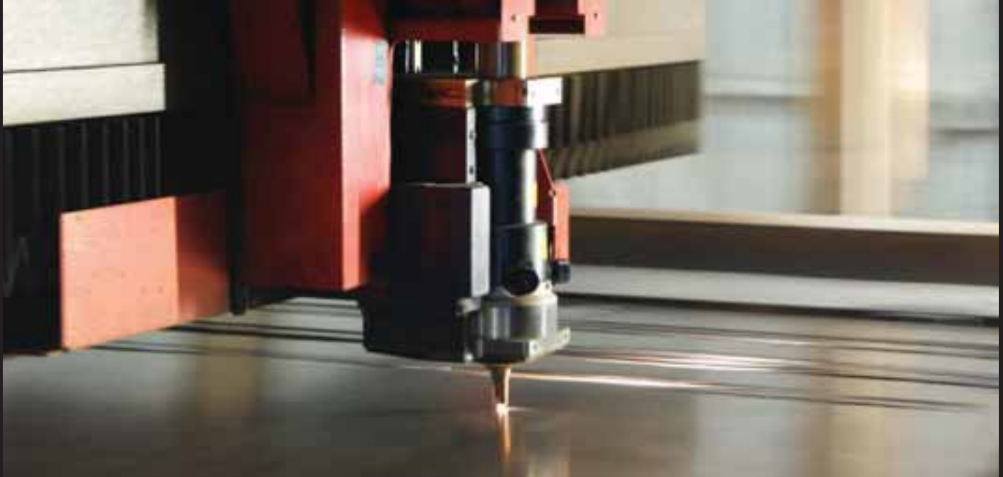
Trasformatore de corte laser para aluminio e distintas aleaciones para la fabricación de componentes.
