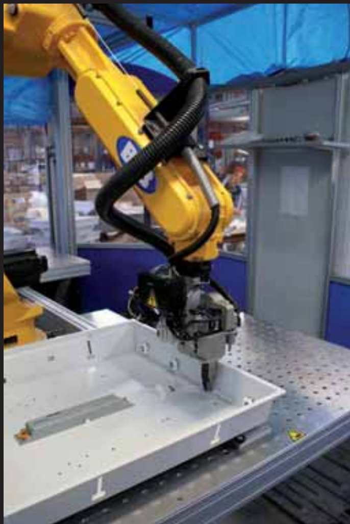
Robot di cablaggio automatico.
