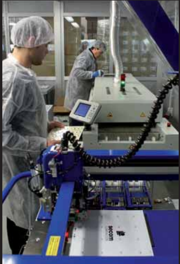
Macchinario Pick & Place e forno di rifusione per convezione.
