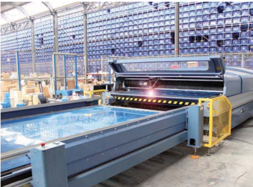
Láser de corte y grabado de PMMA / Cutting and engraving laser of PMMA.
