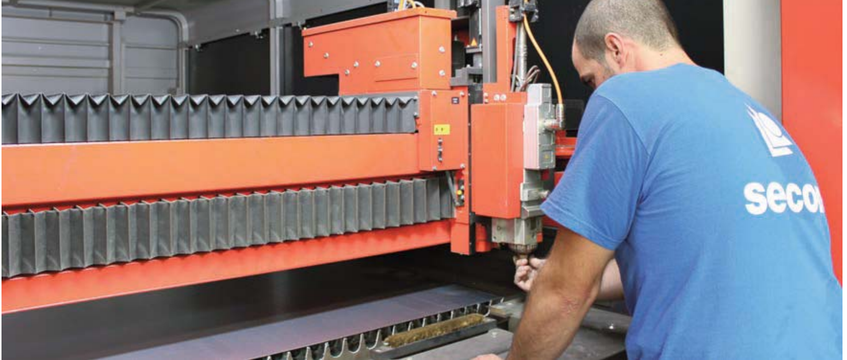
Equipo de corte laser para aluminio y distintas aleaciones para la fabricación de componentes. Laser cutting equipment for aluminum and other alloys for the manufacture of components.
