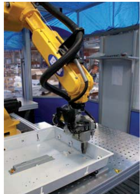
Robot de cableado automático / Robotized wiring cell.
