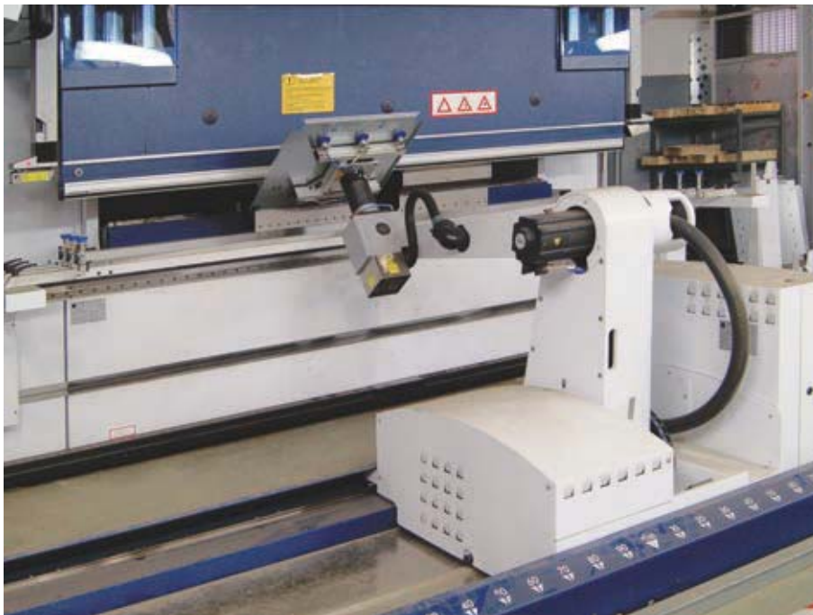
Plegadora con robot / Robotized folding machine.
